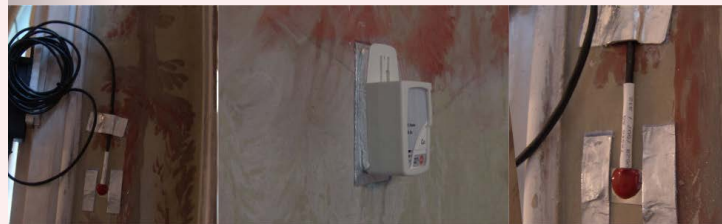
Messfühler verklebt mit der Malschichtoberfläche
