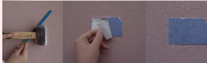
Leicht abziehbar nach Tränkung mit Siedegrenzbenzin
