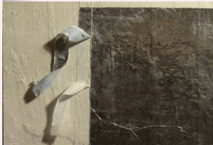
Das PU-Coating läßt sich leicht abziehen
