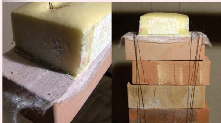
Beschichtung Ziegel 02 und Prüfung der Tragfähigkeit der Verklebung
