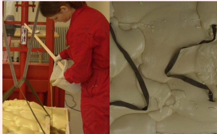
Herstellen des PU-Schaumkissen mit Holzarmierung
