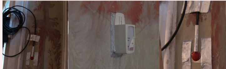
Messfühler verklebt mit der Malschichtoberfläche
