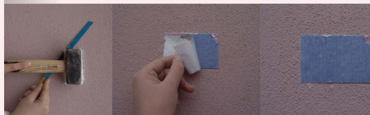
Leicht abziehbar nach Tränkung mit Siedegrenzbenzin
