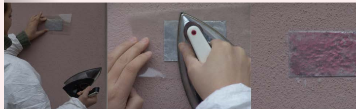
Messfühler verklebt mit der Malschichtoberfläche
