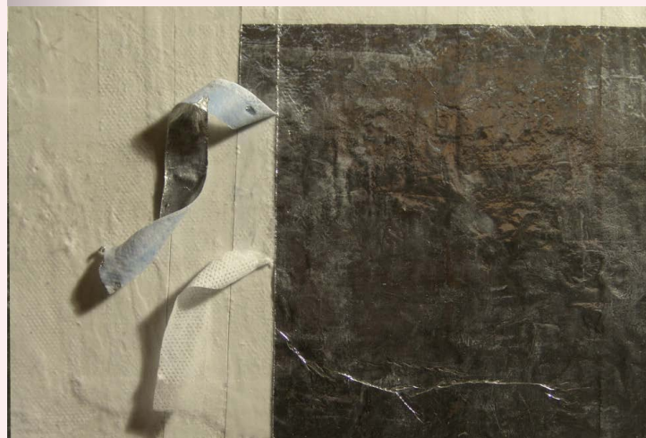
Das PU-Coating läßt sich leicht abziehen
